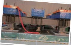
振動台実験風景 ((株)大林組 技術研究所)
